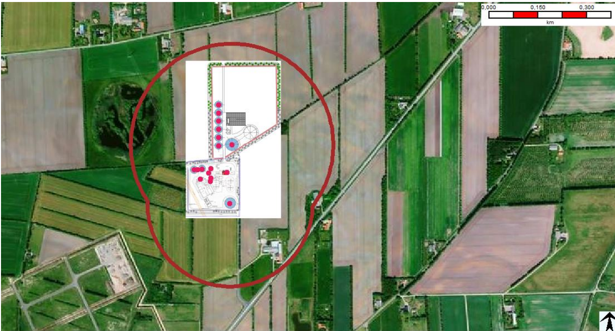
Figur 0-1: Maksimal konsekvensafstand for til et eksplosionsovertryk på 0,05 bar(g) forårsaget af totalt kollaps af begge gaslagre.
