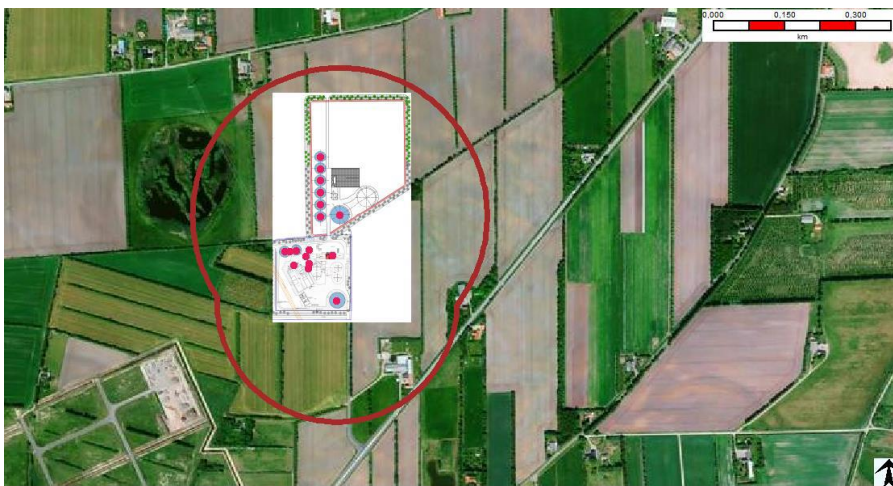
Figur 3: Foreningskurve over eksplosionsovertryk på 0,05 bar(g) = maksimal konsekvensafstand = planlægningszonen
