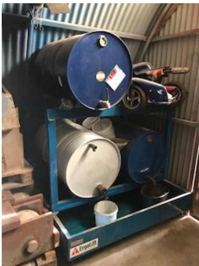
Billede 1. Opbevaring af kemikalier på spildbakke.
