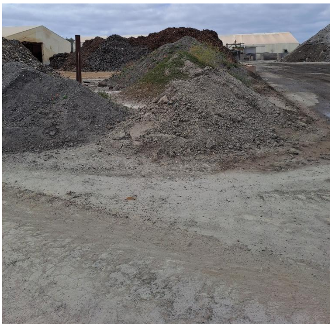
Bunker med genanvendt slagge.
