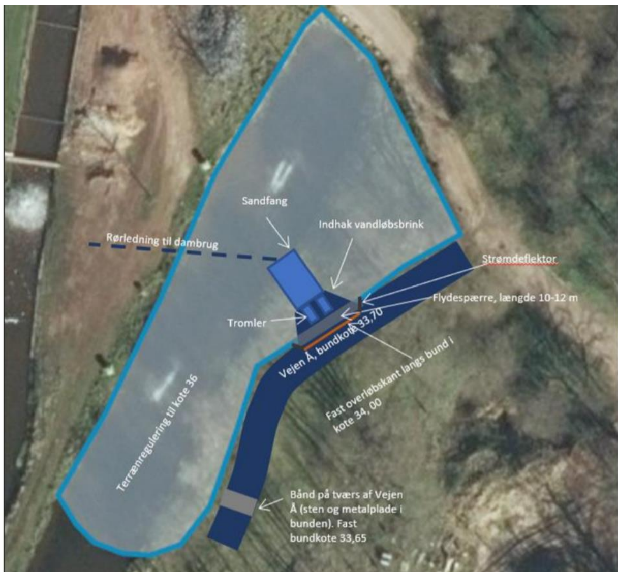
Fig. 1 Indløbsindretning med faunasigter og sandfang før pumper etableres i bund af sandfang (fra realiseringsrapport – vandløb)
