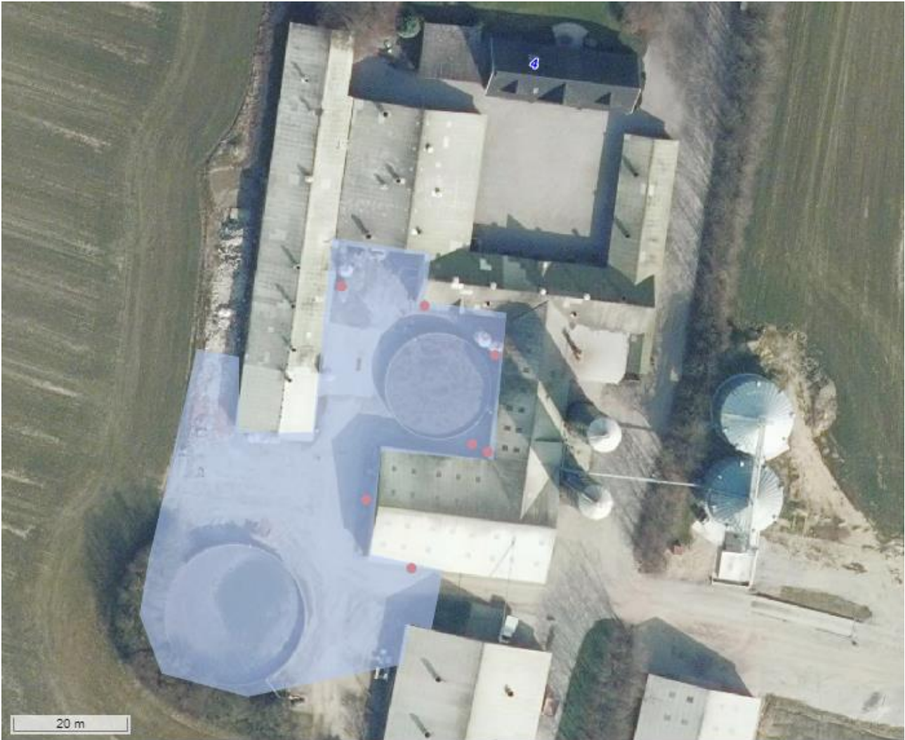
Figur 1: Enten skal alle afløb indenfor det lyseblå område afspærres, så alene tagvand – og ikke overfladevand – kan løbe i afløb til dræn, eller de to gyllebeholdere skal udstyres med gyllealarm. Kendte afløb er markeret med rødt.
