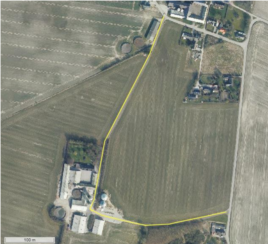
Figur 4: risiko for væsentlige støvgener fra indkørselsvejen (gul streg) kan ikke udelukkes på baggrund af afstanden til de omboende, særligt på de første 150 m af indkørselsvejen fra øst (nederst til højre på kort). Vilkår beskriver derfor, at indkørselsvejen skal forefindes og vedligeholdes i en stand, så der ikke sker væsentlige støvgener for de omboende.
