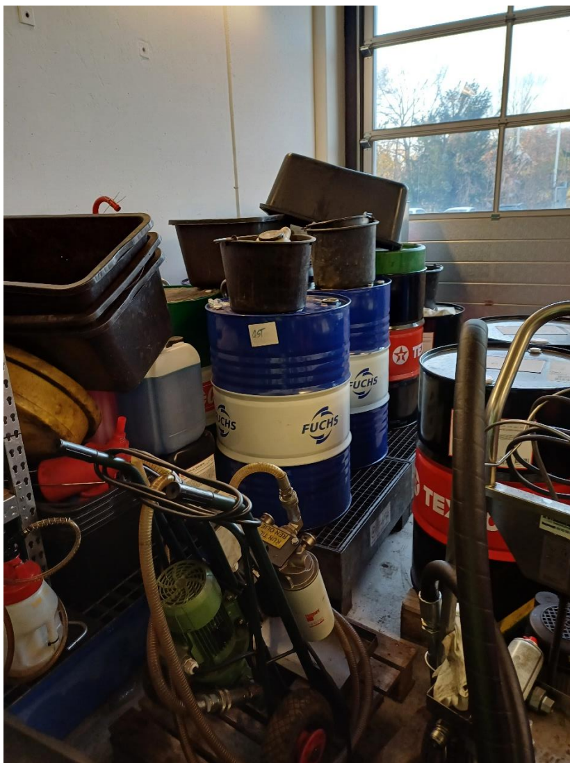
Foto 7. Oplag af olie og kemi på spildbakker. Grabværksted
