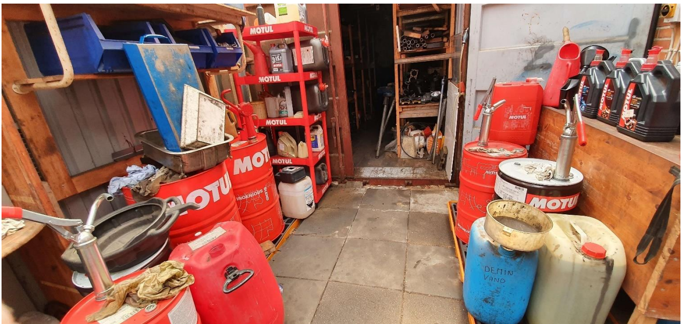
Oplag står på spildsikring i skur. Tromler og dunke ved siden af er enten tomme eller mindre emballager under 20 liter.
