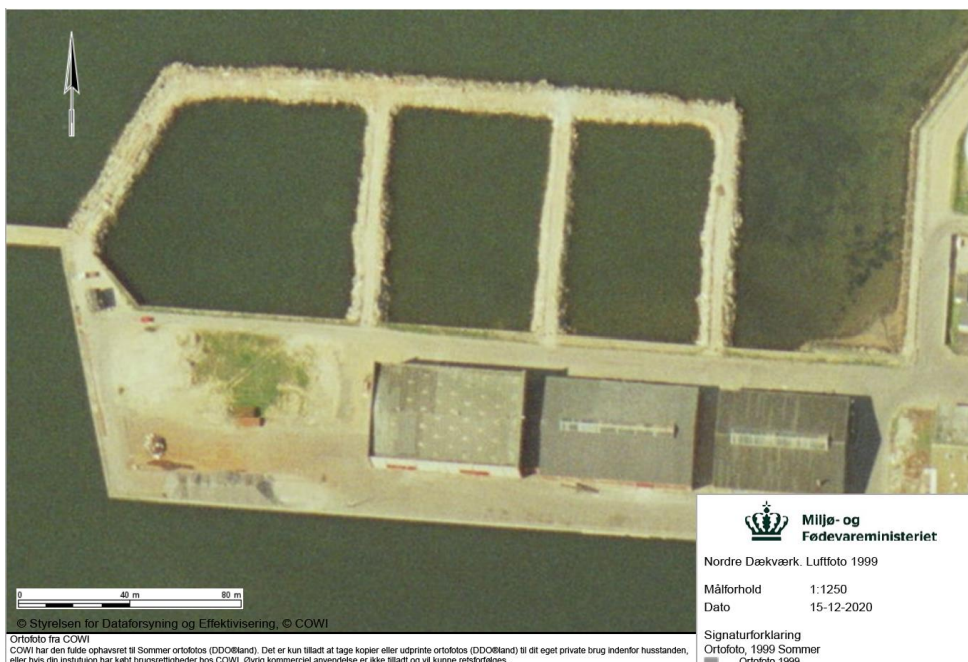
Figur 5. Luffoto Struer Havn 1999. Indfatningen af sedimentdepotet er etableret.
