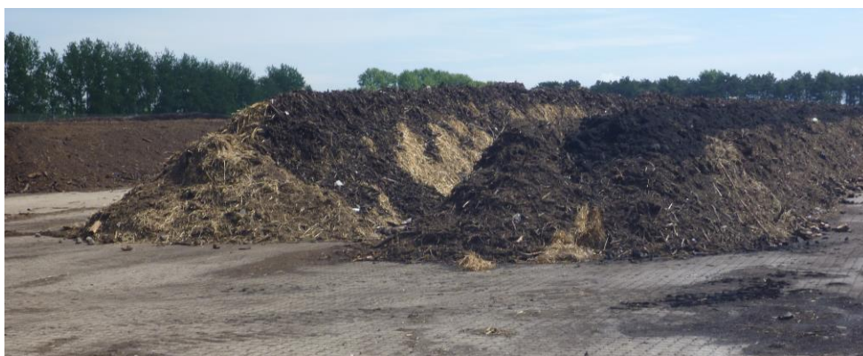
Foto3: miler til kompostering af have- parkaffald og spildevandsslam. Af foto ses desuden, at enheden er belagt med SF-sten.
