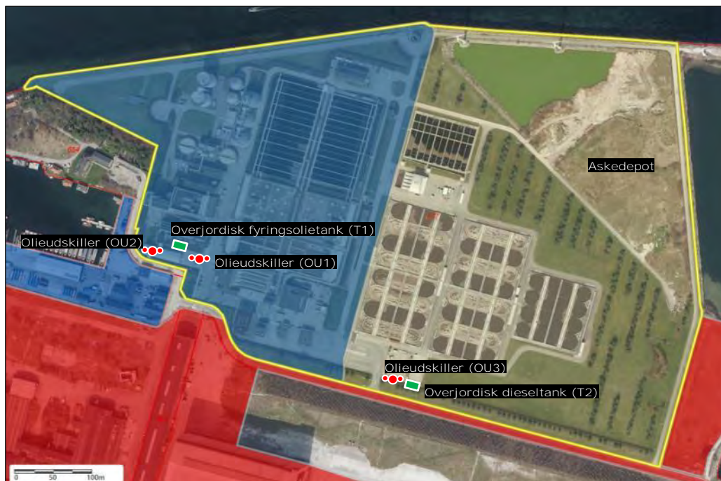
Figur 3.1. Oversigtskort med placering af tanke og olieudskillere på BIOFOS Lynetten, markeret med gult område. V1- og V2-kortlægningen er markeret henholdsvis med blå og rød skravering. Kilde på figur: Danmarks Arealinformation
