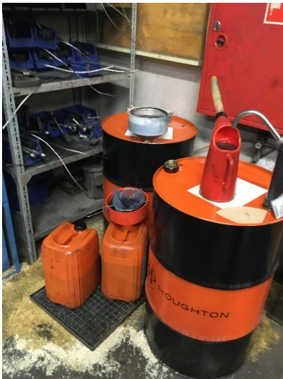
Opbevaring af olie til filtrering, uden spildsikring.
