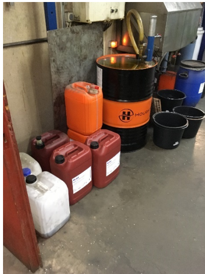
Opbevaring af diverse olier, uden spildsikring.
