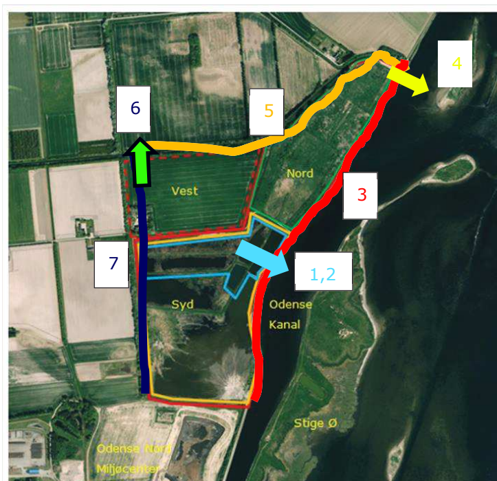
Figur 6-5 Illustration of de syv kilder til belastning af akvatiske recipienter. Fire punktkilder: 1,2 samt 4 og 6 Tre "linjekilder": 3, 5, 7
