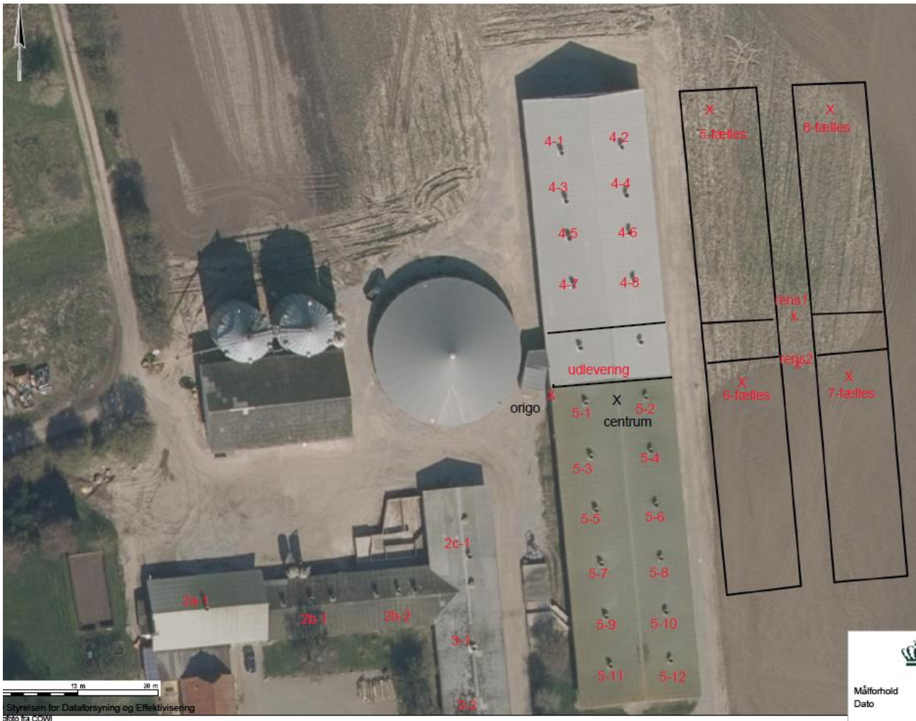
Figur 4-3: Afkastenes placering og markering af luftcentrum (origo).
