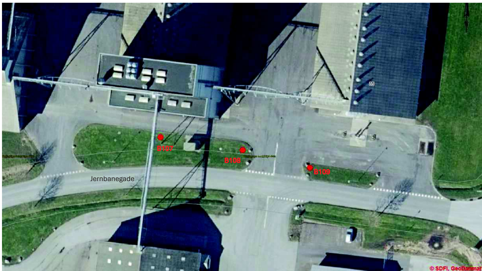
Placering af permanente borer til monitoring af grundvand. – Danish Agro Vrå
