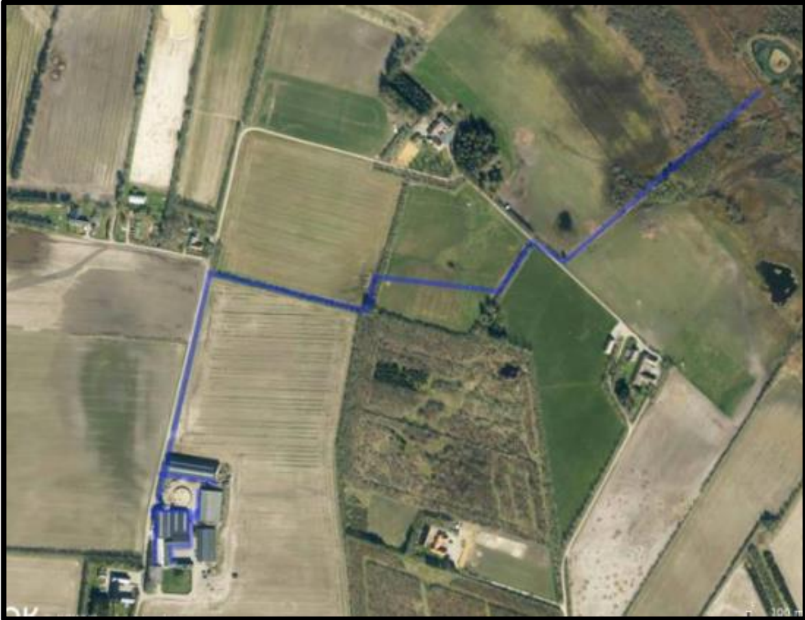
Figur 9. Hvordan tagvand ledes til Troldholm Bæk.
