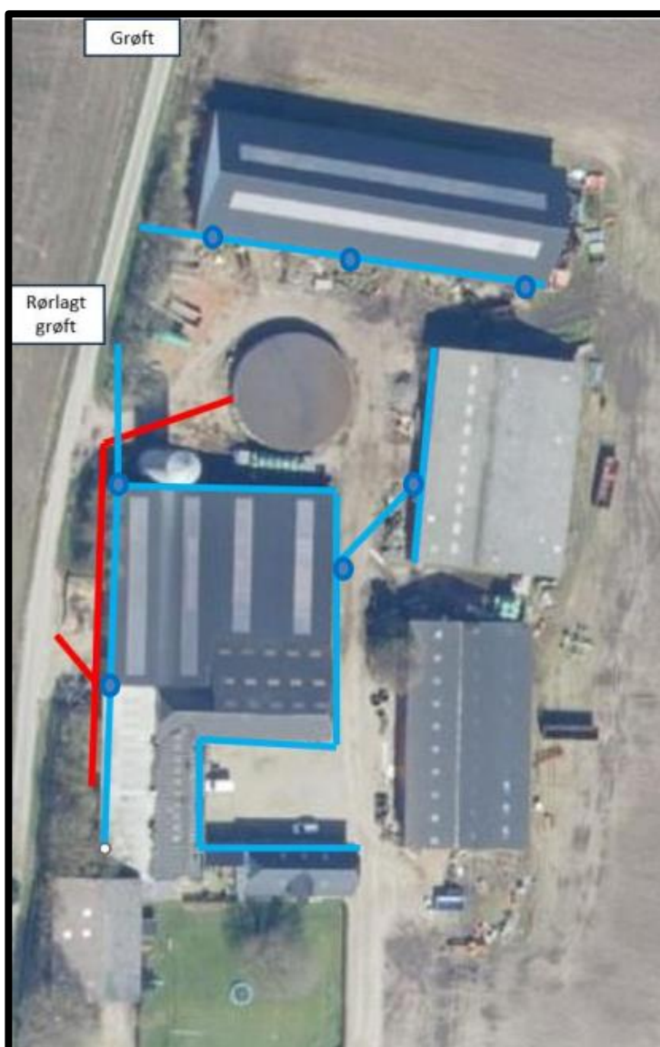
Figur 8. Afløbsplan, hvor blå streg er tagvand og rød streg er gyllerør.
