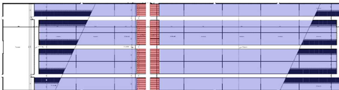
Figur 4: Angivelse af de 3.372 m 2 produktionsareal i stald 2, hvor 3.173 m 2 er med delvis spaltegulv (markeret med blå) og 199 m 2 er med dybstrøelse + spalter (markeret med rødt). Til venstre ses foderladen (hvidt område).
