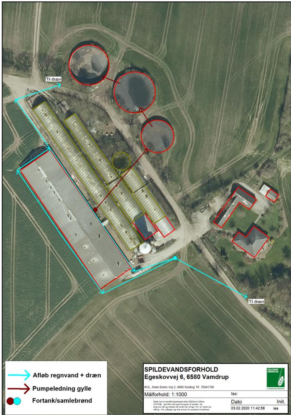
Figur 3 Oversigt over afløbsforhold på Egeskovvej 6
