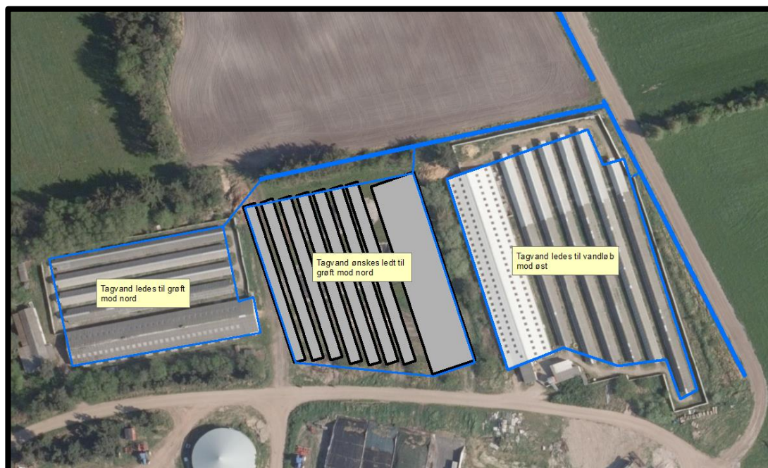
Figur 7. Oversigt over udledning af tagvand
