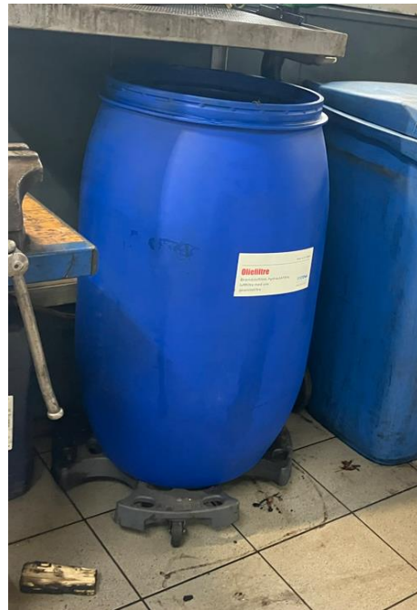
Spildolie og ny olie i tønder og tanke på spildbakke i tilstødende rum til værkstedet, 2023
