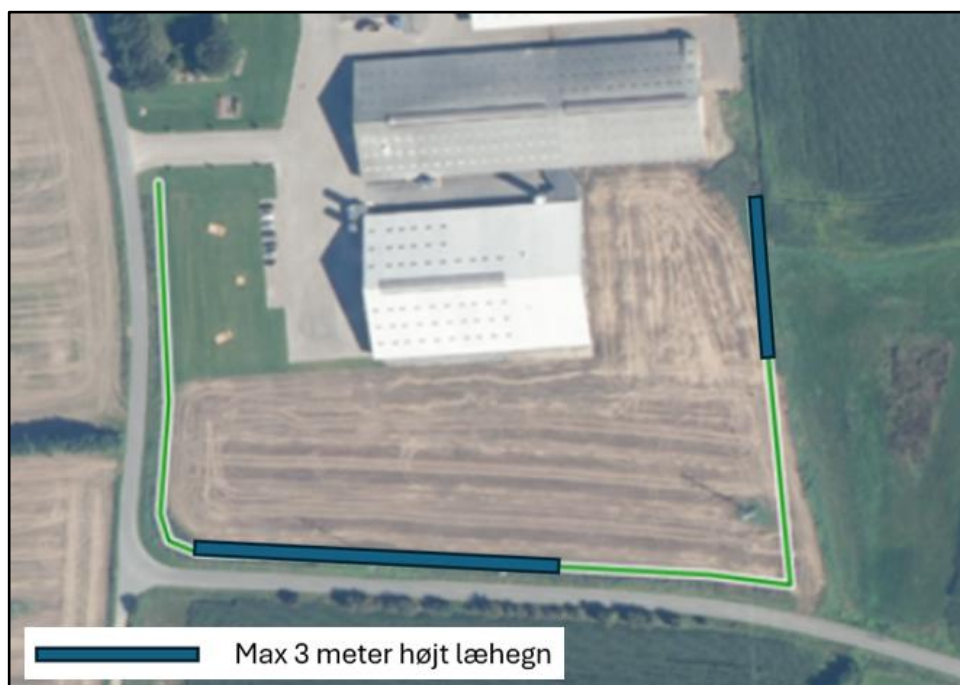
Figur 10. Under elledningernes forløb må beplantningen have en maksimal højde på 3 meter. Figur udarbejdet af ansøger.
