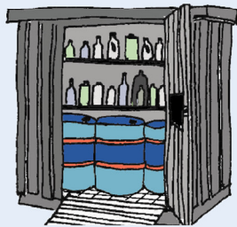
Figur 2: Udendørs opbevaring i container med dobbelt bund.
