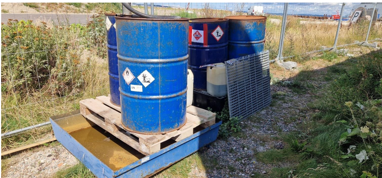
Opbevaring af flydende farligt affald. Står på spildbakke, som dog ikke er overdækket.
