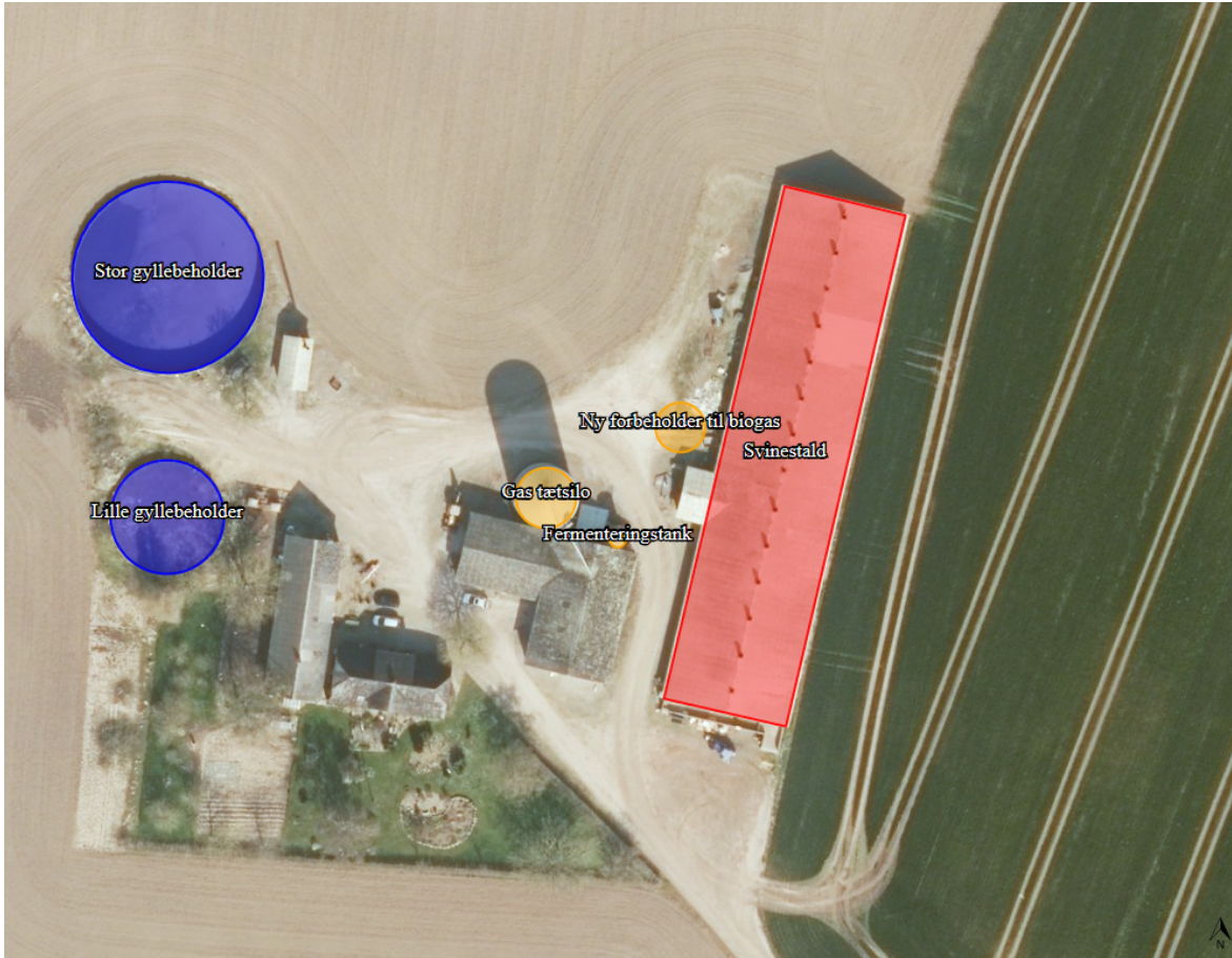
Figur 1. placering af produktionsarealer (rød) og gødningsopbevaringsanlæg (blå)
