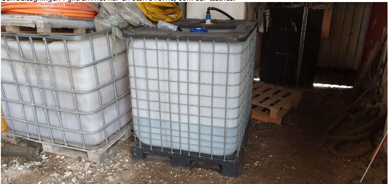
AdBlue opbevares i en pallettank på jord. Umiddelbart udenfor væggen, som ikke slutter tæt, er der en tankningsplads med kloak afløb.
