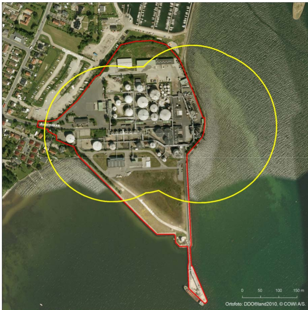
Figur 1: Gult område: sumkurven for dødsfaldsrisiko for alle scenarier med giftige, brandfarlige (med flammepunkt \leq 55^{\circ}\text{C} ) og/eller miljøfarlige stoffer. Rødt område: virksomhedens areal.
