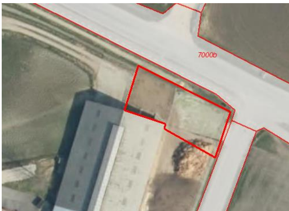
Figur 2. Placering af mødding i løbegården skal mod nord overholde afstandskrav til offentlig vej på 15 meter. Derfor må mødding ikke placeres inden for det røde markerede område i løbegården. (Luftfoto 2021)
