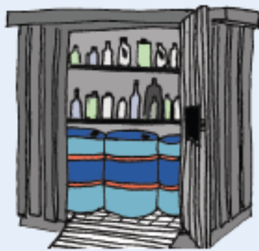
Figur 2: Udendørs opbevaring i container med dobbelt bund.
