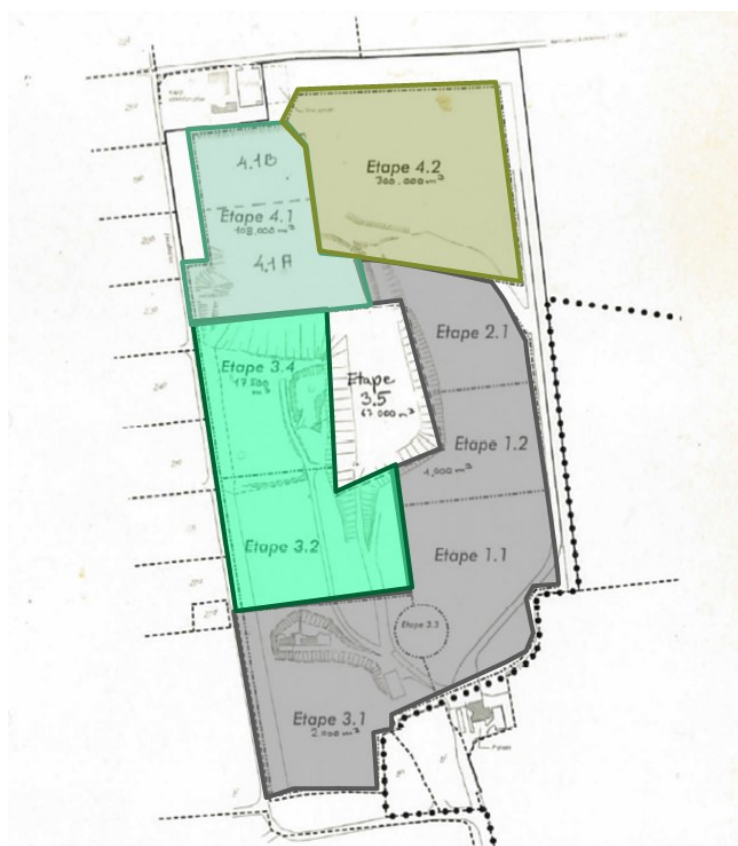
Opdelingen af Forlev Miljøanlæg i etaper med farver der angiver membrantype: Tynd plastmembran, Plast/PE membran , lermembran, ler og HDPE membran.
