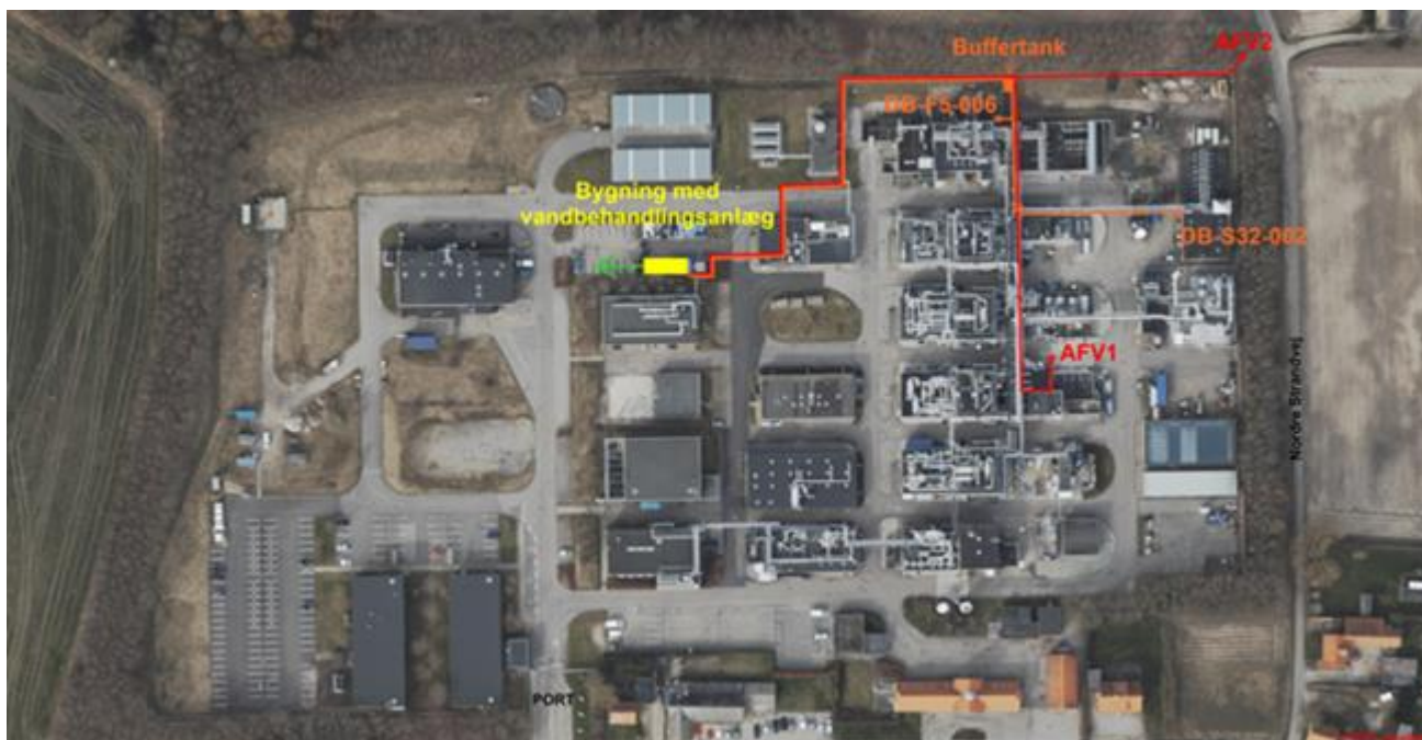
Figur E. 1: Lundbecks produktionsområde, og placering af bygning med vandbehandlingsanlæg og rørsystemet. Tegningen viser rørføring fra AFV1 og AFV2 samt to bygningsdræn. Rørføring for AFV4-AFV6 er ikke endeligt fastlagt, og derfor ikke vist.
