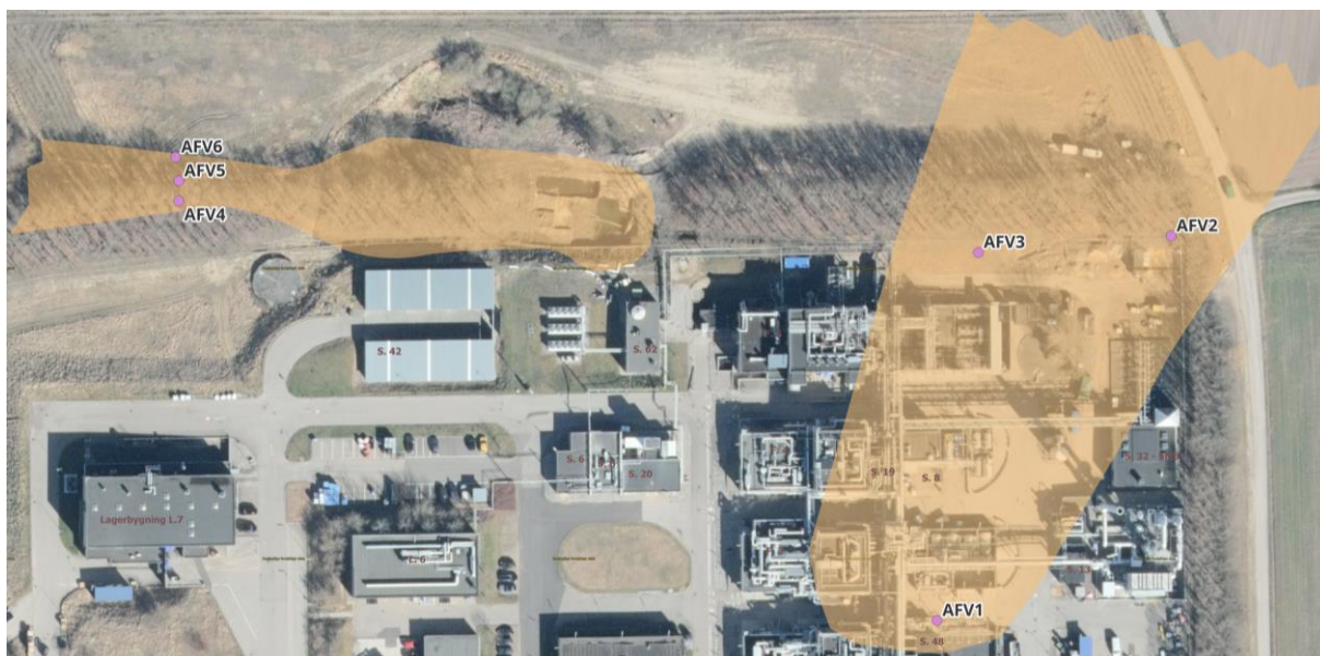
Figur D.3: Placering af afværeboringer og omtrentlig udbredelse af forureningsfaner ved bygning S.48 og S.62.
