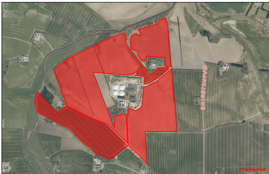
Figur 2. Angivelse af de marker, hvor der må ske udspredning af urent overfladevand fra biogasanlægget.
