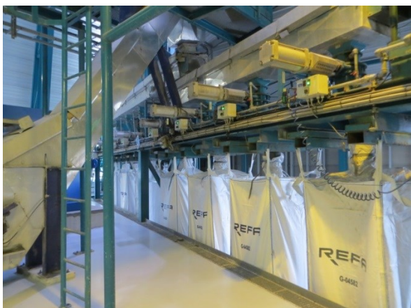
Figur 4. Opsamling af restprodukter fra de tre ovnlinjer placeret i hal
