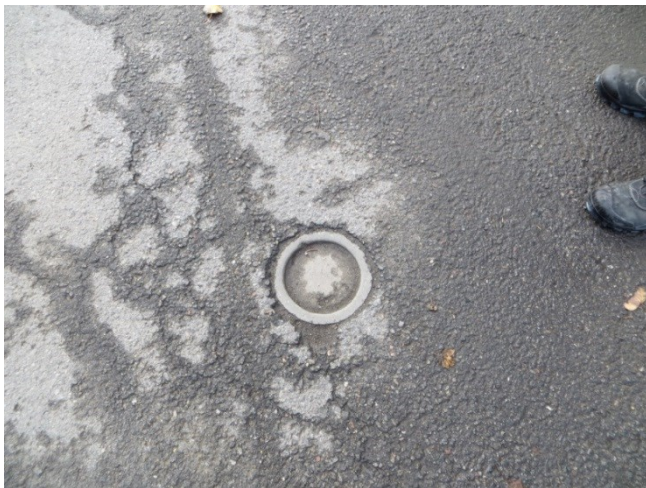
Figur 6. Monitorings- og dybdeboring i gården ved olieudskiller.
