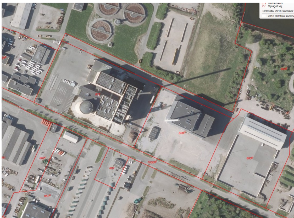
Luftfoto af Fjernvarme Horsens, kraftvarmeværk sommer 2018 – affaldsforbrænding og gasturbine til venstre, biomassevarmeværk i midten. Nyt flislager er indrettet på omkranset plads syd for bygning i den højre del af billedet. Matrikler er angivet med røde streger.
