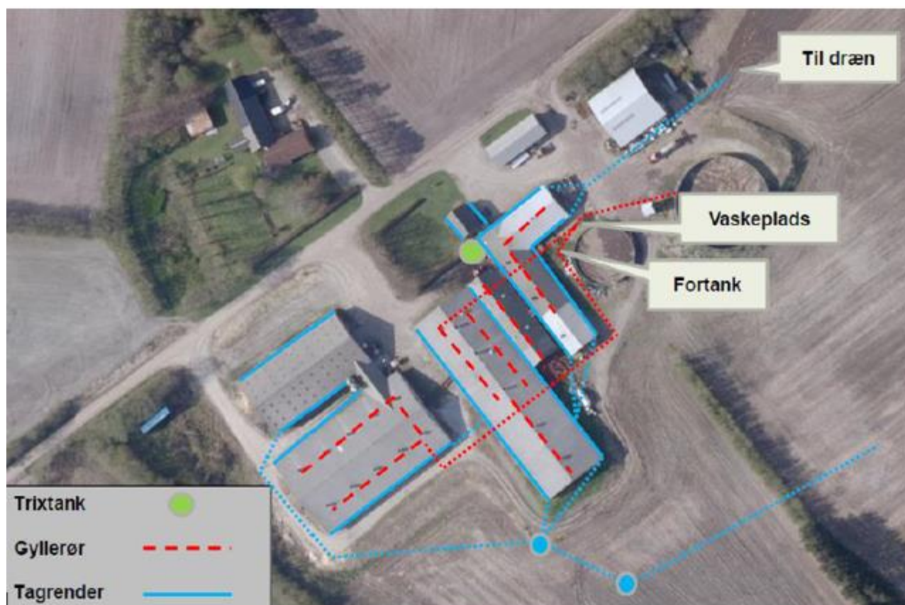
Figur 6. Oversigt over gyllerør og tagvand.
