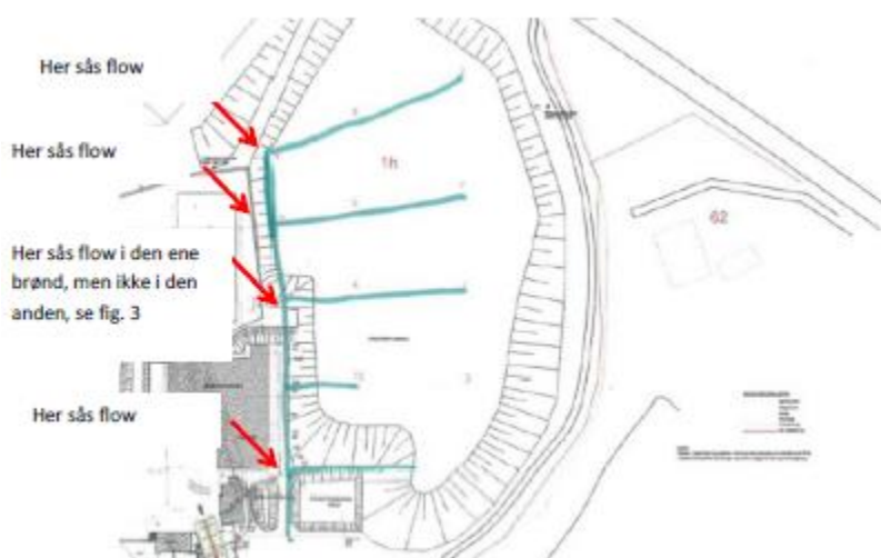
Fig. 3 Der sås flow i perkolatsamlebrøndene. I en enkelt brønd stod perkolatet op over drænrøret. Grøn streg angiver drænstrengene spulet i perioden 2015/2016.
