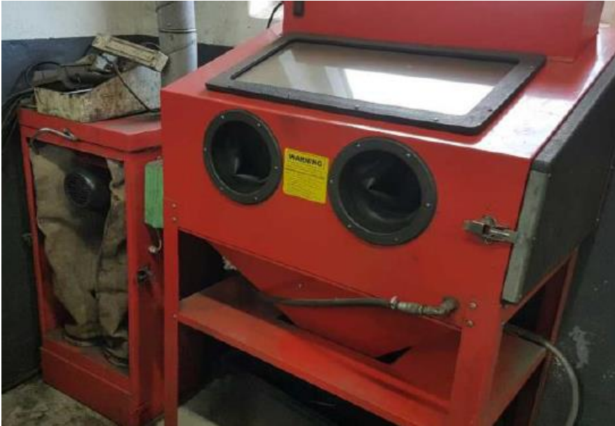
Billede 3. Sandblæser med posefilteranlæg, 2017
