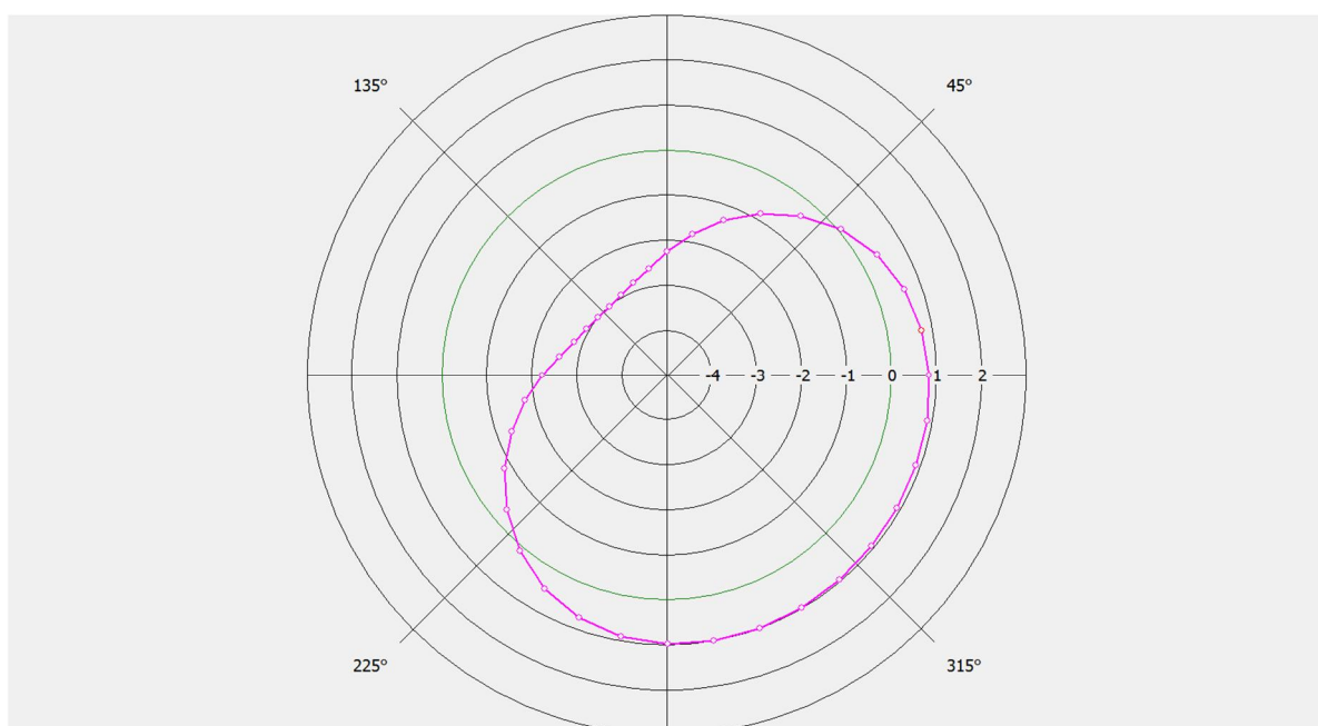
Figur 2: Retningskarakteristik for Shredder. Retning 0/360 grader er mod øst.
