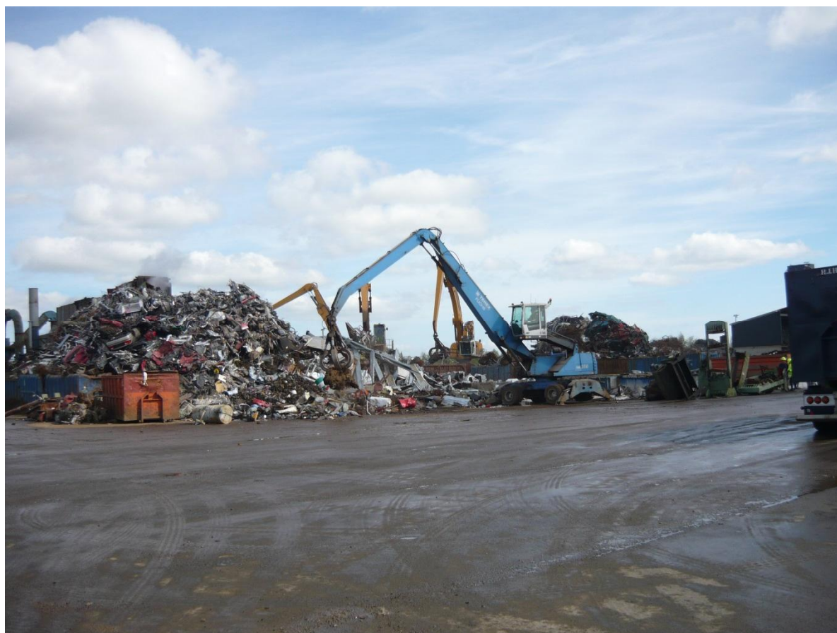
Figur 3: Gravemaskiner som føder Shredder og gravemaskine som sorterer formaterialer set fra sydvest
