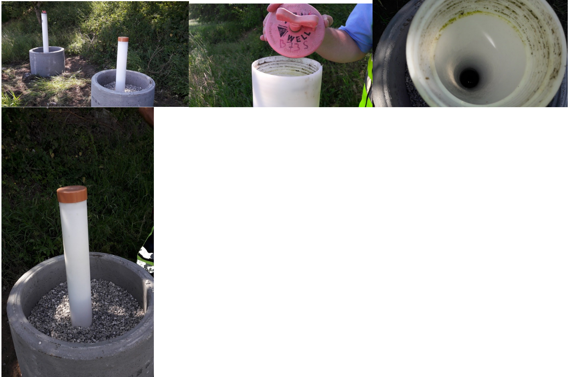
Figur 9 Perkolatbrønd 73 og grundvandsboring 73s med formodet DGU nummer 170.1729. Det er grundvandsboringen der har prop med gevind.
