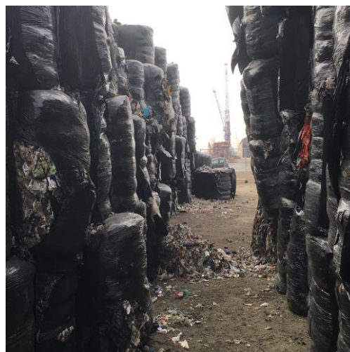
Billede 2. Oplag af affaldsballer der er i stykker
