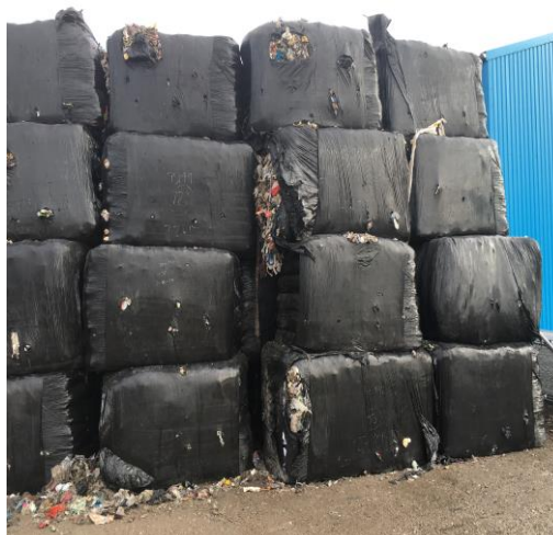
Billede 1. Oplag af affaldsballer der er i stykker
