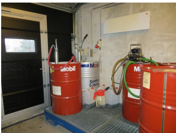
Billede 12: olieprodukter placeret på spildbakker
