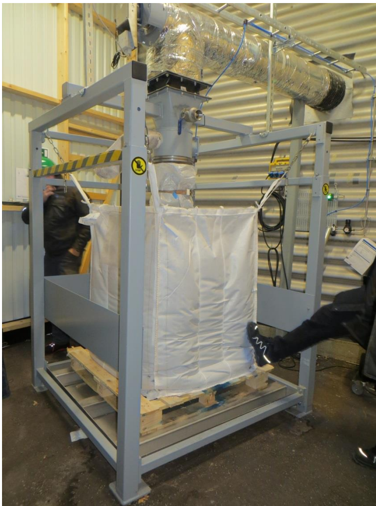
Billede 6: opsamlingsæk til restproduktet fra posefilteret
