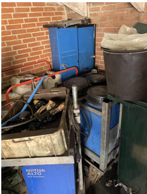
Billede 3. Opbevaring af farligt affald indendørs og på tæt betonbelægning.
