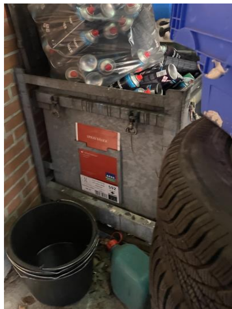
Billede 4. Opbevaring af spraydåser indendørs og på tæt betonbelægning.
