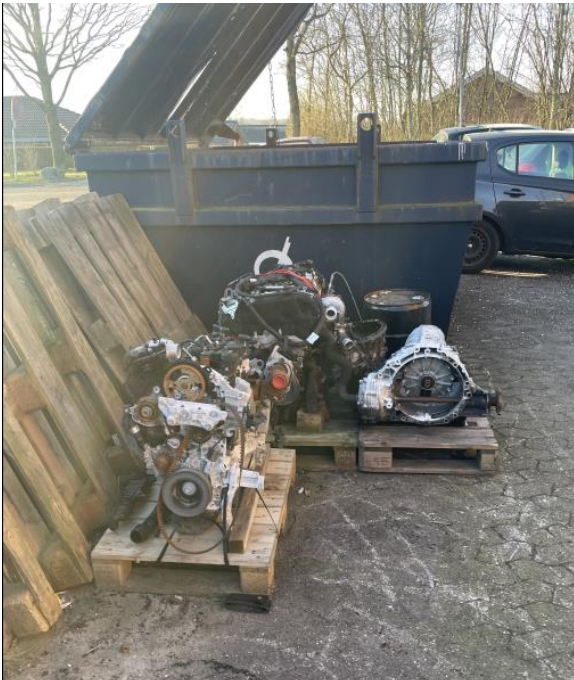
Billede 6. Opbevaring af brugte motorer udenfor på SF-sten og uden overdækning.
