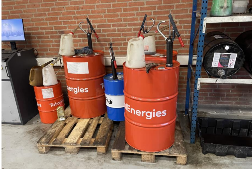
Billede 2. Opbevaring af olie på værkstedet. Der er en spildbakke under reolen.
