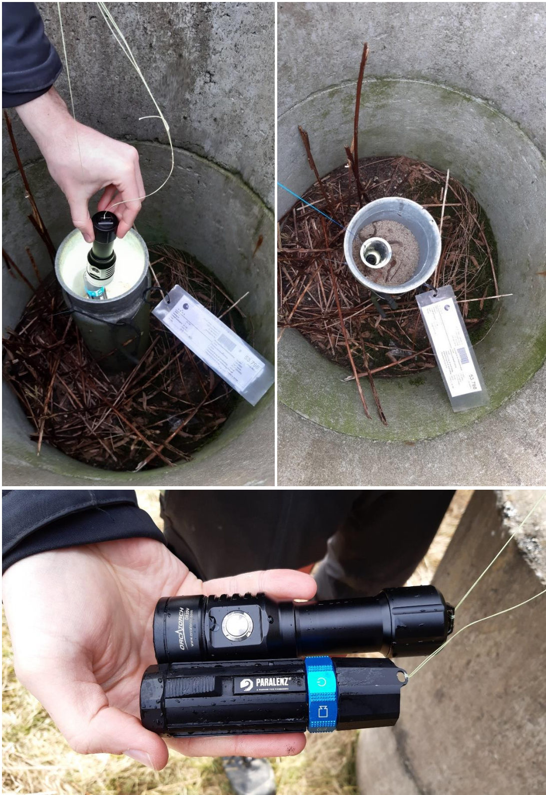
Figur 1. TV-inspektion af DGU 53.797 og 53.798. Øverst tv: Kamera og lygte sænkes ned i DGU 53.798. Øverst th: Sikret via en fiskesnøre, sænkes kamera og lygte langsomt længere og længere ned i boringen indtil bunden nås. Nederst: Udstyret - Paralenz Dive Camera (nederst) og Orca Torch Scuba Video Light (øverst).
