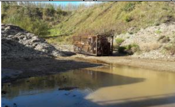
Shreddet glasfiber placeret uoverdækket uden dørs. Oplægget ligger på et befæstet areal. Det kunne dog konstateres at en del af det shreddede glasfiber er spredt på arealet udenfor befæstningen og på den nærliggende vold. Desuden løber overfladevand fra oplægget ud på ubefæstet areal.
