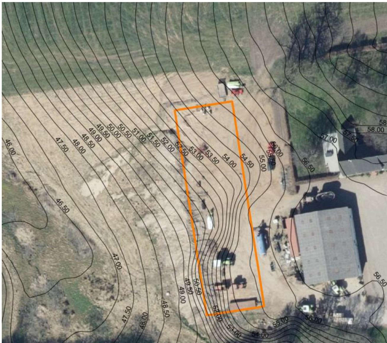
Figur 4. Placering af maskinhus og højdekurver inden opfyldning med sand.
