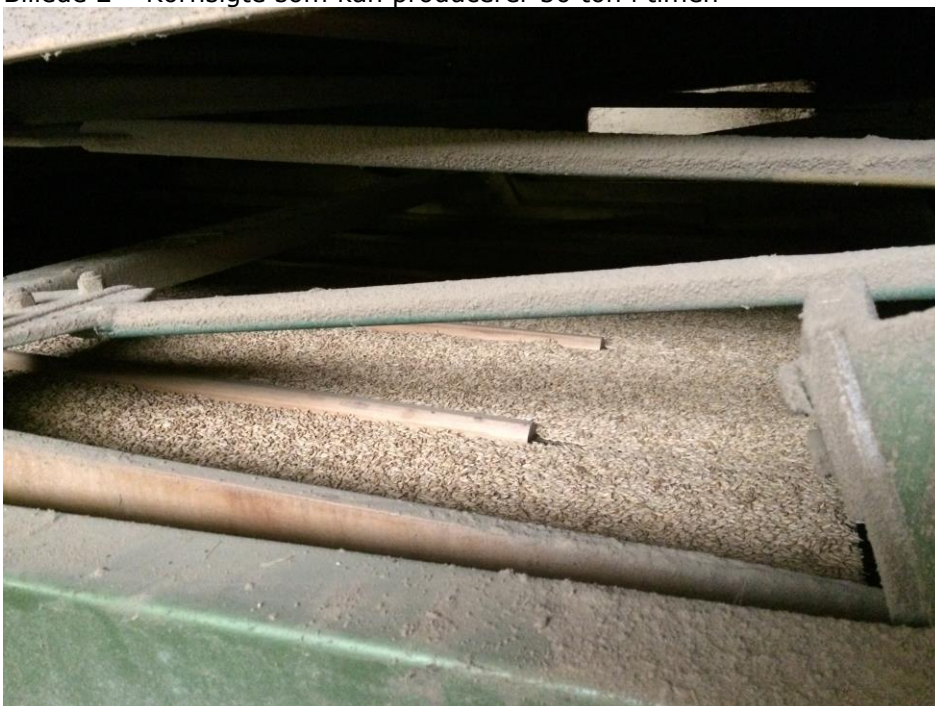
Billede 2 – Kornsigte som kan producerer 50 ton i timen
