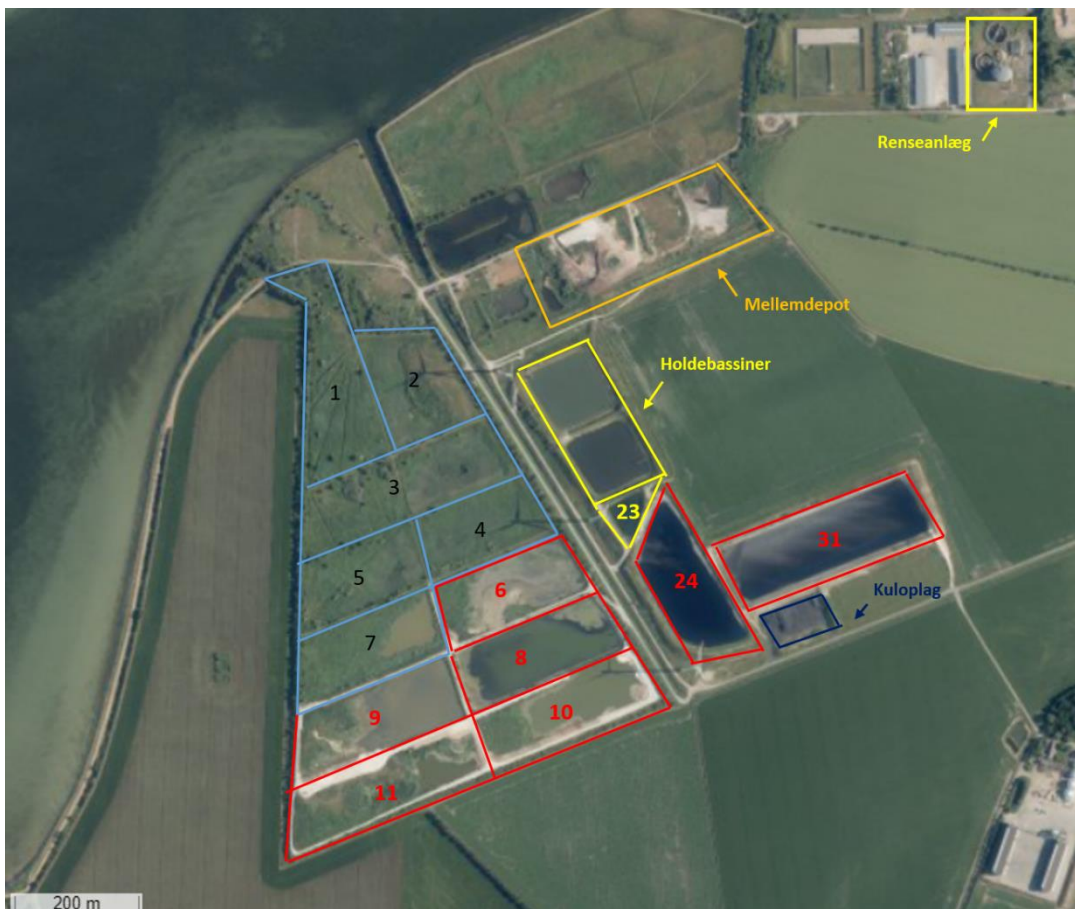
Figur 2: Korttegning over virksomhedens roejordsdeponi og mellemdapot beliggende ved Savnsø Vig. Nedlukkede jordbassiner er markeret med blå, åbne/aktive jordbassiner er markeret med rødt, mellemdapot for roepulp og grønt er markeret med orange. På arealet ligger desuden et kuloplæg tilknyttet sukkerfabrikken (markeret med mørkeblå) samt et hydrolysebassin (bassin 23) og 2 holdebassiner, som hører til spildevandsrens anlægget (markeret med gult). Kuloplæg og spildevandsbassiner var ikke omfattet af tilsynet. Korttegningen er en skitsetegning og angiver udelukkende et overblik – der er ikke tale om målfaste afgrænsninger.
