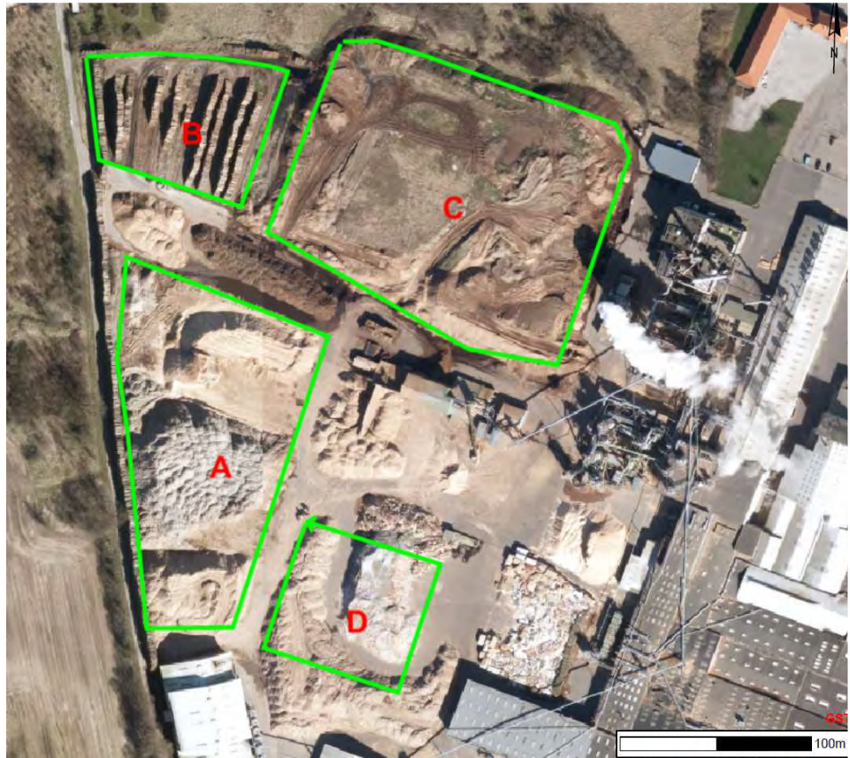
Figur 3.4: Udtrækning af oplag af træ. A: Savværksflis, 5-15 m højde. B: Rundtræ: 4-5 m højde. C: Brændsel 5-10 m højde. D: Altholz (genbrugstræ) 5-15 m højde.
