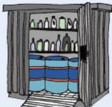
Figur 2: Udendørs opbevaring i container med dobbelt bund.
