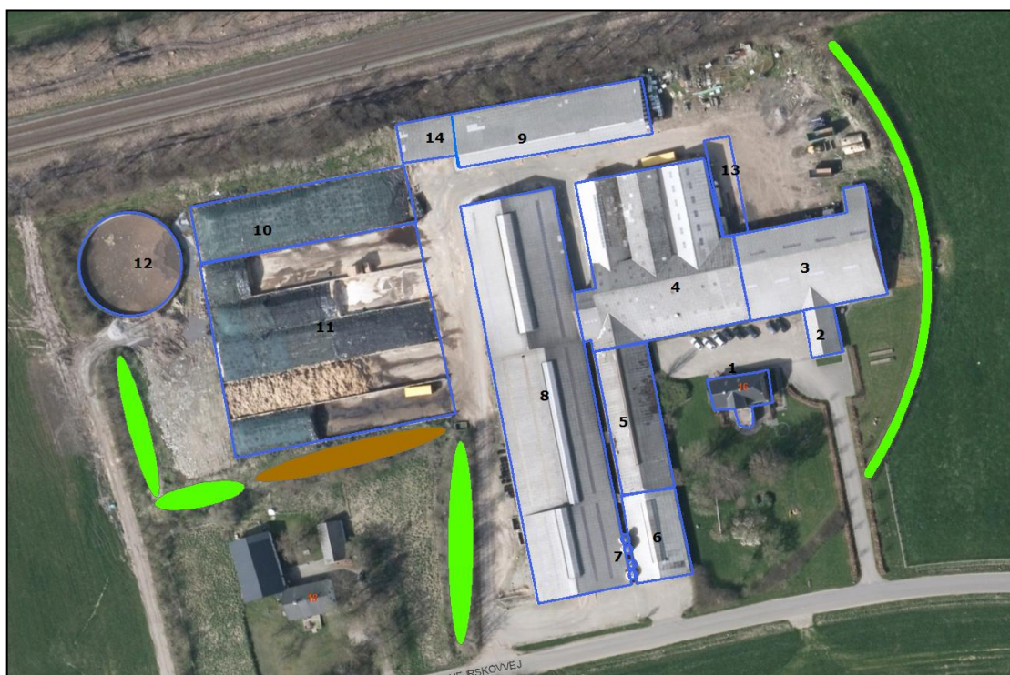
Figur 4. Principskitse for afskærmende beplantning (grøn) og jordvold (brun).
