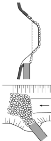
Figur 1. Placer og udform af udlobet så mindst mulig erosion af bund og brinker opstår. Det kan fx sikres med stenræmning. Hvor højdeforholdene giver mulighed for det, kan udlobet udføres så afløbets vand løber eksempelvis i faskane eller åbningstrappe.
