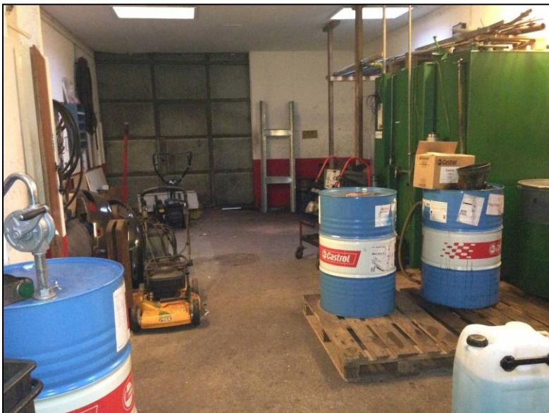
Foto af lokalet med kompressor og opbevaring af flydende råvarer og -affald fra tidligere tilsyn. Delvis ombygget pga. kontor. Grøn tank til spildolie.
